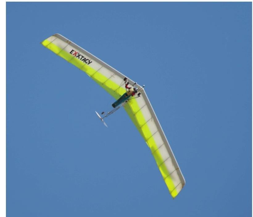
La nécessité de dissocier l'axe de poussée du moteur de l'aile devenait impérative. Roland MAGALLON créa le chariot pendulaire dont le principe est toujours utilisé dans cette catégorie.
